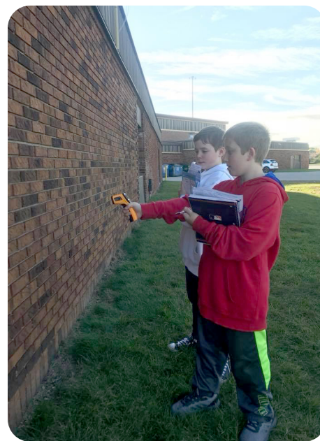
Élèves mesurant la température de surface à l'aide d'un thermomètre IR (avec l'aimable autorisation de Susan Oltman)
